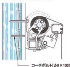
▼コンクリート造天井納まり
